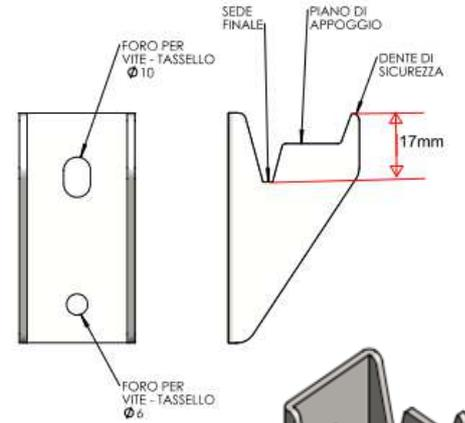
**步骤 3:** 划出支座 (D)位置，然后用螺丝和销子  $\text{Ø}10\text{mm}$  (上边的孔)固定到墙上。
