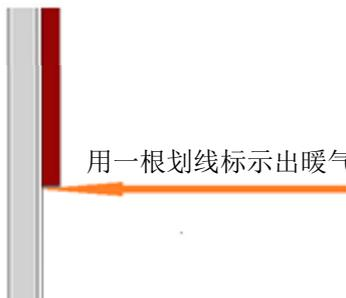
去掉暖气片后，在划线上方 12 是毫米，在暖气片中心位置处，钻孔然后打入  $\varnothing 6\text{mm}$  的销子用于固定保险扭键。
