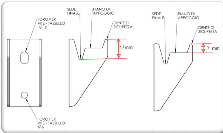
将暖气片就位后，确保暖气片水平，如果不水平，调节支座使其水平。
